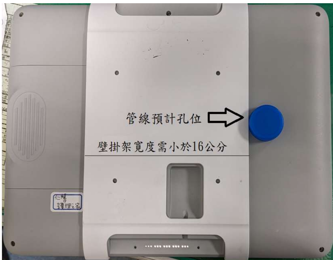
管線預計孔位
